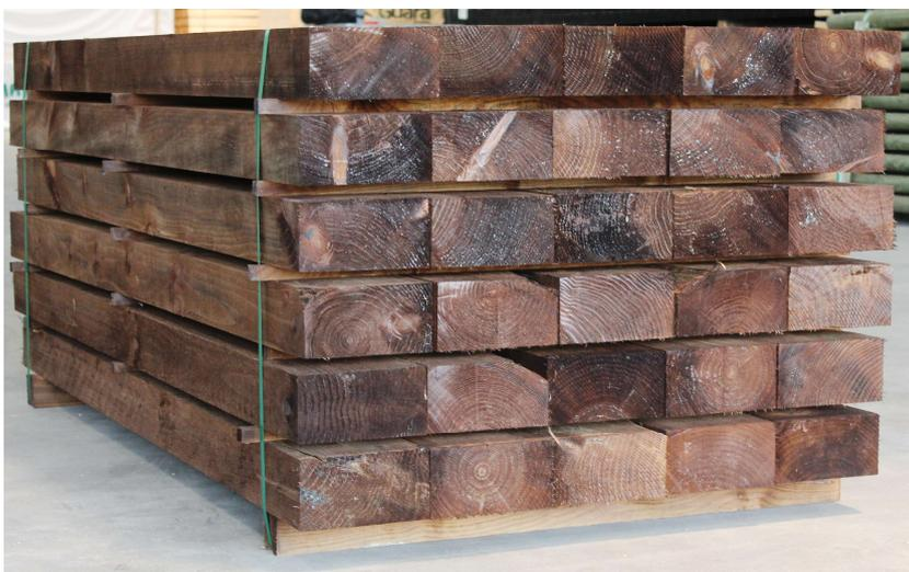
Método de aplicación empleado: Sistema Bethell, autoclave vacío-presión-vacío
